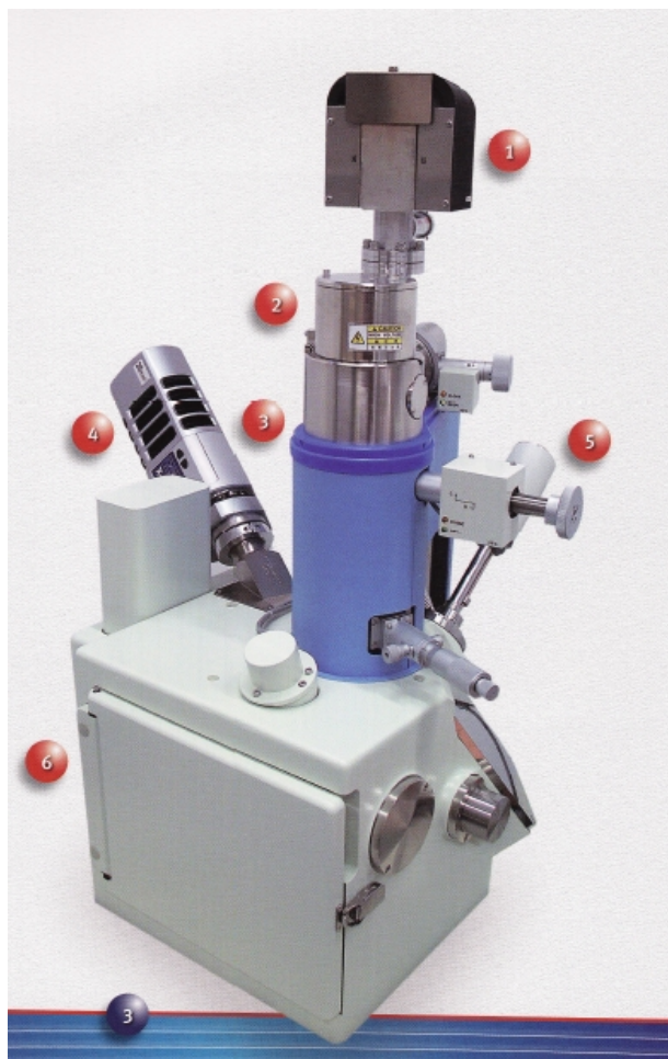
Slika 13. SEM model: JOEL JSM-6610LV (1-jonska pumpa, 2-elektronski top, 3-kolona, 4-EDS detektor, 5- CL detektor, 6-komora za uzorke
