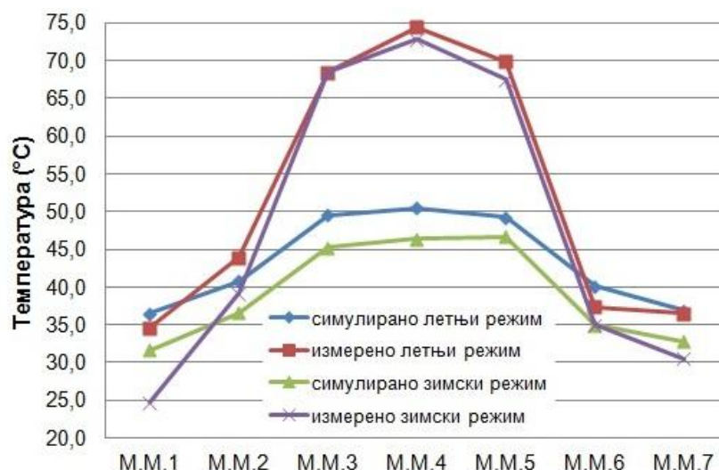
Слика 36. Поређење симулираних и измерених температура ваздуха у пресеку 5 (секција за сушење премаза)
