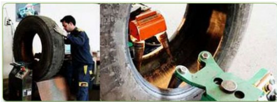
Slika 3.2.8. Vizuelna kontrola pneumatika za komercijalna vozila
