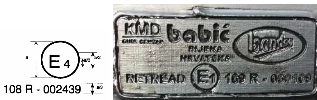
Slika 3.2.7 Prikaz obeležavanja pneumatika po UNECE-u
