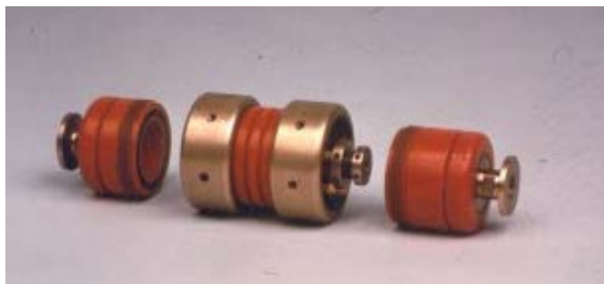
Slika 6.1a. Fotografija komore sa zamenljivim elektrodnim sistemom.
