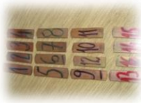
Slika 6.3 Prikaz termomehaničke obrade sinterovanih i livenih uzoraka
