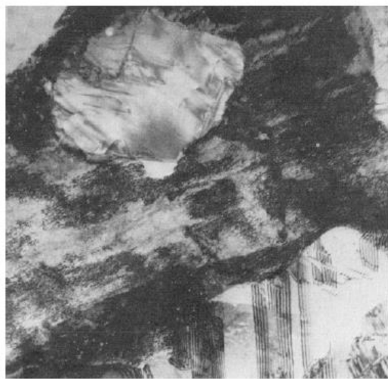
Slika 3.1 TEM mikrofotografija delimično rekristalizalog uzorka Cu-8,5mas.%Al ( \varepsilon=80\% , T=300^{\circ}\text{C} , t=4\text{h} ); 21625x [9]
