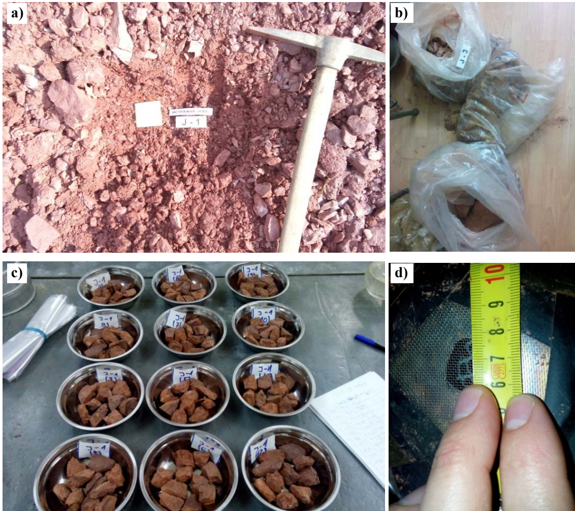
Slika 7.16 a) Istražna jama na km 22+850, b) Izgled uzoraka pre obrade, c) Uzorci sa km 22+850 u metalnim posudama i, d) Postavljanje žice od 1 mm preko otvora od 2,5 cm
