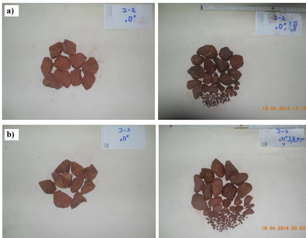
Slika 7.18 a) Uzorak sa lokacije 28+650 pre opita i nakon drugog ciklusa, b) Izgled uzorka sa lokacije 30+200 pre opita i nakon petog ciklusa
