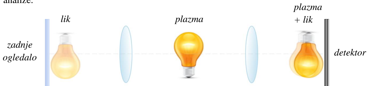
Slika 3.3.6 Ilustracija principa vraćanja optičkog lika u plazmu radi provere njene optičke debljine metodom zadnjeg ogledala. Sijalica u ovom slučaju imitira plazmu.
