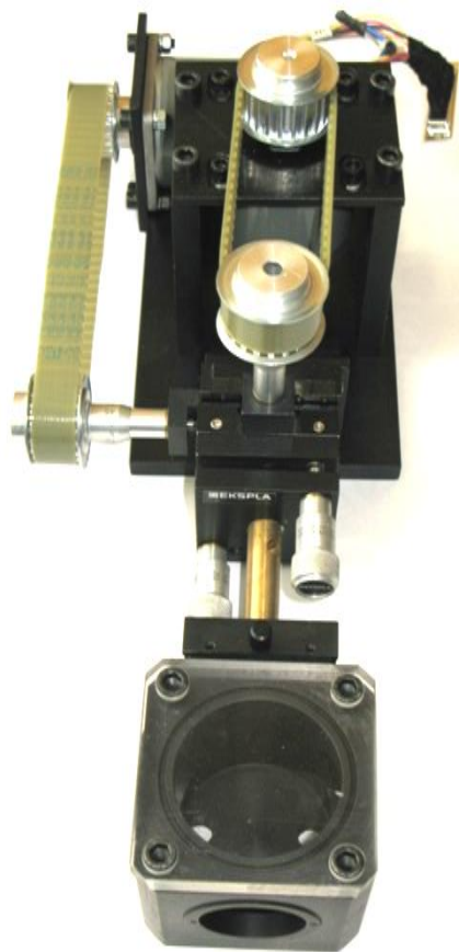
Slika 2.1.1 Izgled (odozgo) komore za uzorke i platforme za x - y pomeranje, dizajniranih i izrađenih u Laboratoriji Fizičkog fakulteta. Sistem pomeranja je regulisan upotrebom koračnih motora, adekvatnog kontrolera i propratnog softvera. Platforma je orijentisana u pravcu upadnog laserskog snopa (slika 2.4.1). Spektroskopska posmatranja se mogu vršiti bočno, a i frontalno, blisko pravcu snopa.
