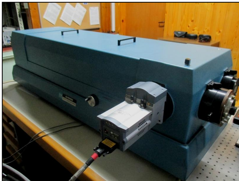
Slika 2.3.2.5 Detekcioni sistem: ICCD kamera Andor iStar DH740 i spektrograf McPherson 209.
