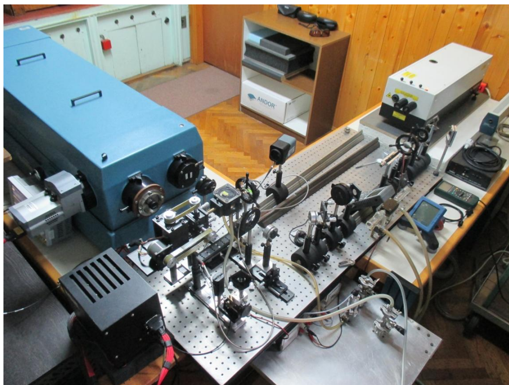
Slika 2.4.2 Eksperimentalna postavka za emisionu spektroskopiju laserski-indukovane plazme.
