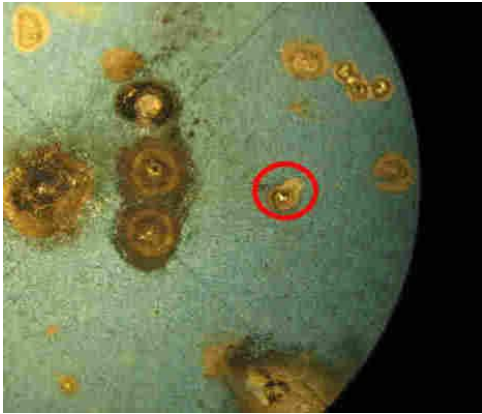
Slika 5.2.2.6. Makroskopski izgled povreda Nd 3+ :YAG lasera , gde je označeno mesto za analizu programom ImageJ.
