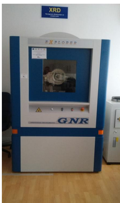
Slika 4.2. X-ray rendgenski difraktometar XRD model Explorer, GNR, sa X-ray rendgenskom cevi talasne dužine Cu-K \alpha (0.154 nm), konfiguracije \theta - \theta
