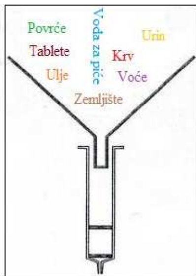
Slika 9. Izgled kolone (kertridža) za SPE
