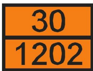
Слика 2. Изглед табле при превозу опасне материје са UN листе
