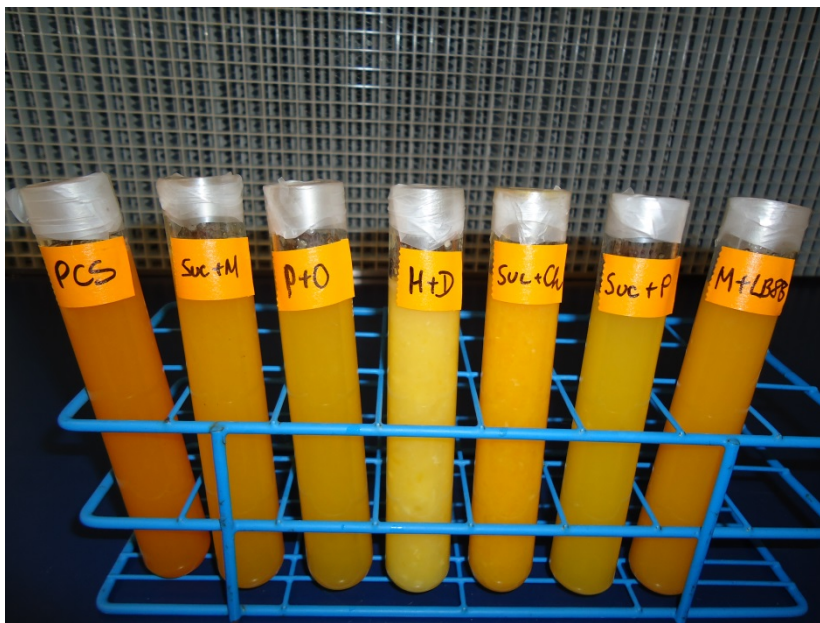
Slika 21. Uzorci iscedenog soka iz zrelih plodova nekoliko somatskih hibrida spremni za kolorimetrijsko testiranje boje pomoću elektronskog kolorimetra GretagMacbeth Color-Eye 3100.
