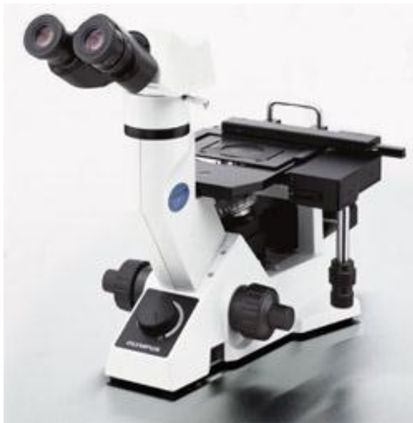
Slika 4.4. Invertni optički mikroskop model OLYMPUS GX41.
