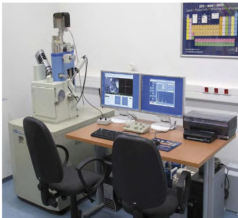
Slika 4.3. Skenirajući elektronski mikroskop model JEOL JSM-6460.
