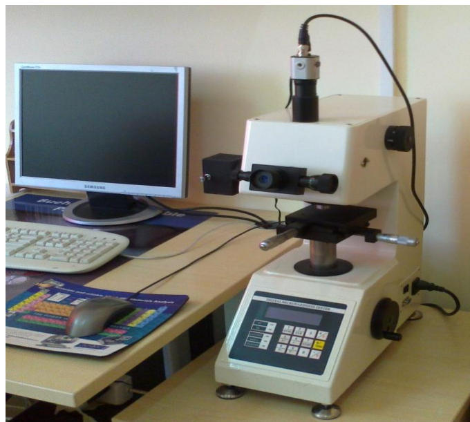
Slika 4.6. Uređaj za merenje mikrotvrdoće po metodi Vickers, model Digital microhardness tester.
