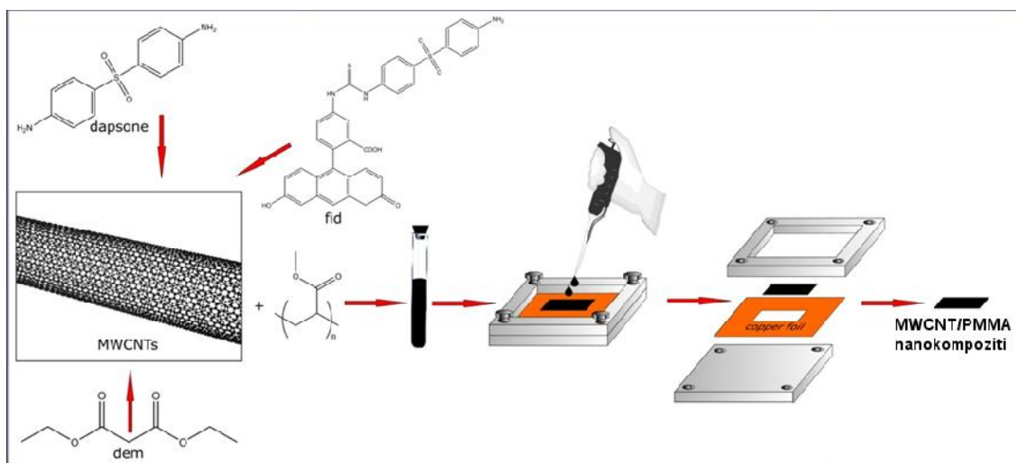
Slika 46. Procedura pripreme kompozita.
