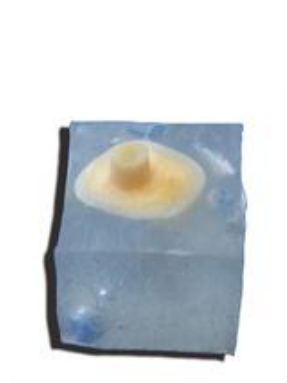
Slika 11. Pripremljeni uzorak za merenje jačine veze smicanjem.
