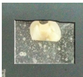
Slika 8. Uzorak pripremljen za SEM i EDS analizu
