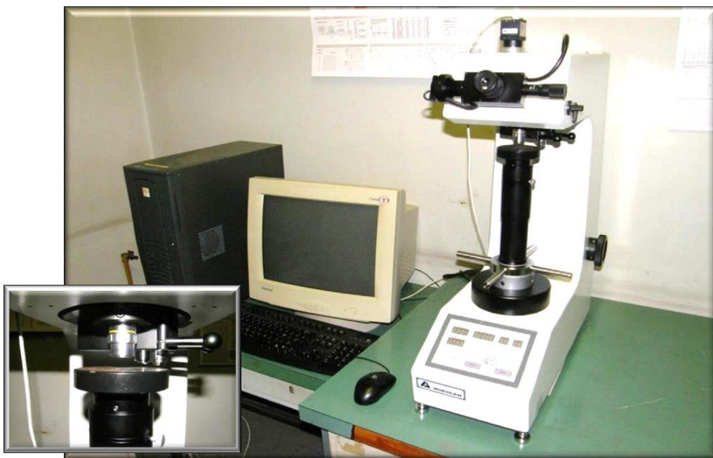
Slika 17. Uređaj za merenje tvrdoće po Vickersu (HV). Malom slikom je prikazano mesto postavljanja uzorka
