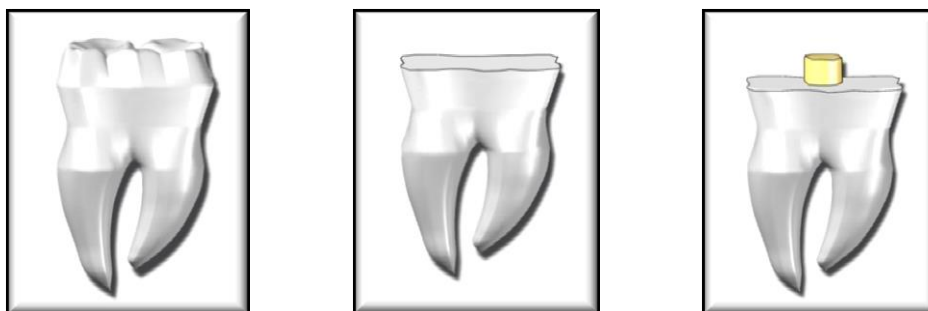
Slika 24. Šematski prikaz korišćenja zuba za ispitivanje jačine veze. Ekstrahovani zubi su presečeni normalno na uzdužnu osovinu zuba u nivou ekvatora kruničnog dela zuba. Preko adheziva polimerizovan je kompozit u odgovarajućem kalupu oblika cilindra, visine 2 mm i prečnika 3 mm
