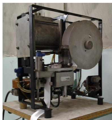
Slika 4.5 a) Gasni analizator STARGAS 898 One i b) Dimomer AVL 4010
