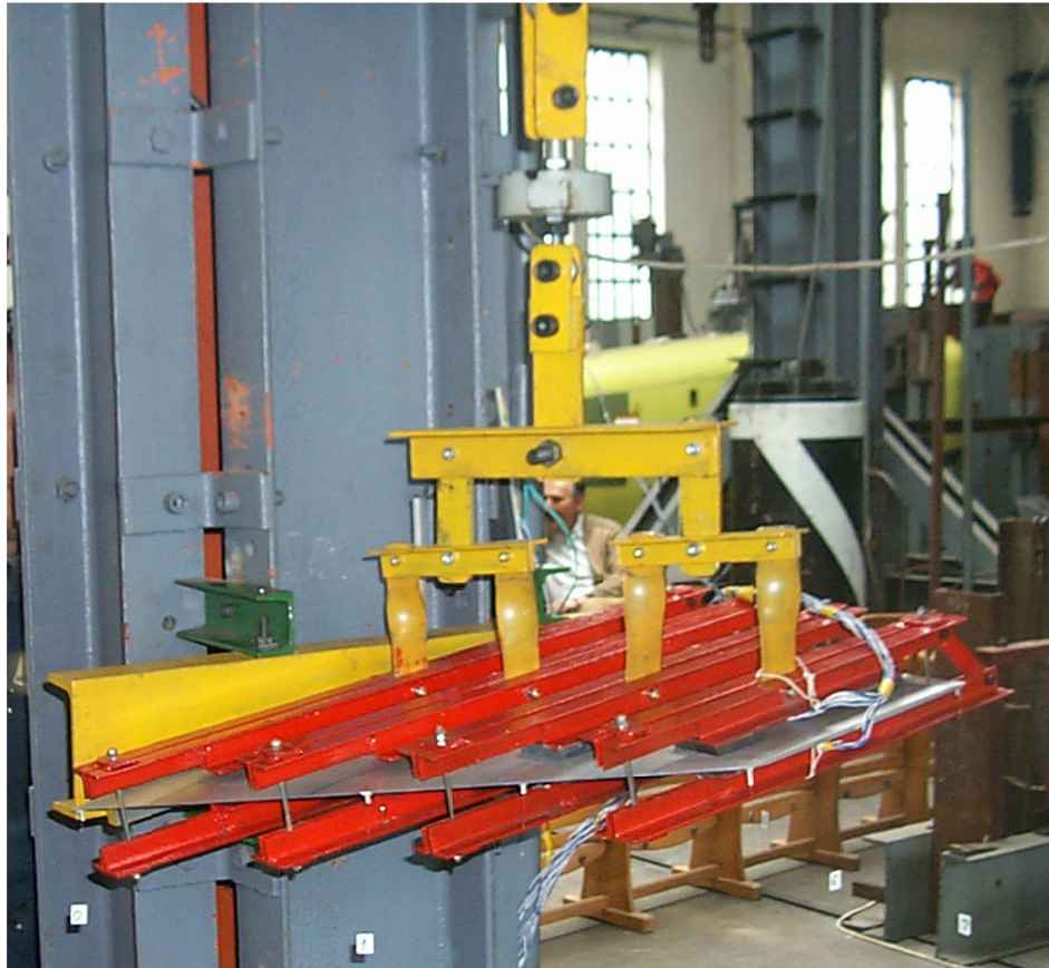
Slika 5.11. Eksperimentalna instalacija za ispitivanje statičke čvrstoće sa test modelom
