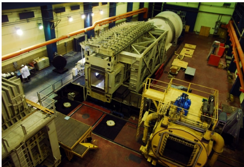
Slika 5.2. Aerotunelska instalacija T38 u VTI-u u Beogradu [131]
