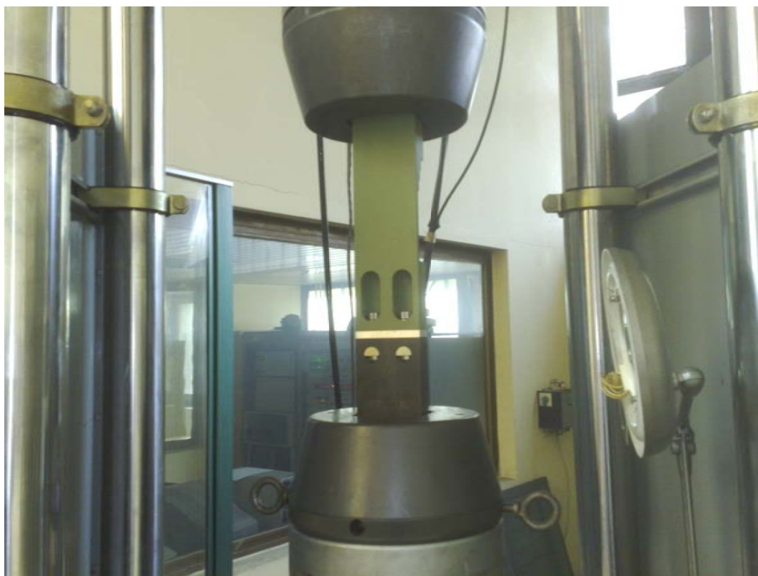
Слика 9.6.1. - Испитивање на замор комплексне епрувете везе крило-труп авиона на систему МТС
