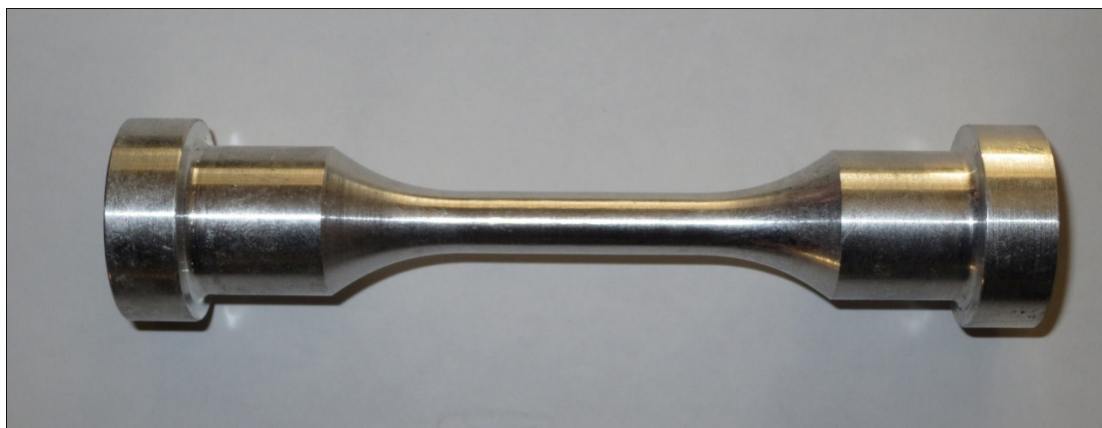
Слика 6.1.1 - Изглед дуралне епрувете за одређивање малоциклусних заморних карактеристика материјала
