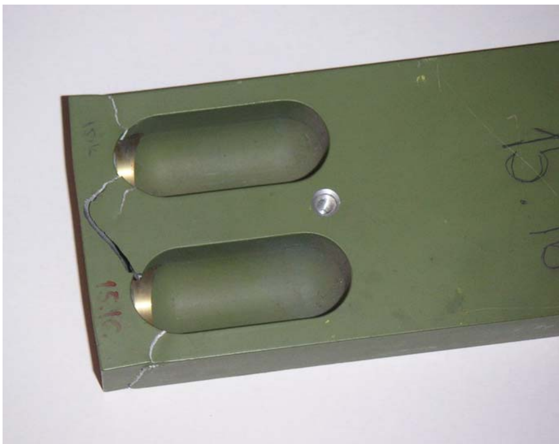
Слика 9.6.2. - Позиција лома после испитивања на замор комплексне епрувете везе крило-труп авиона
