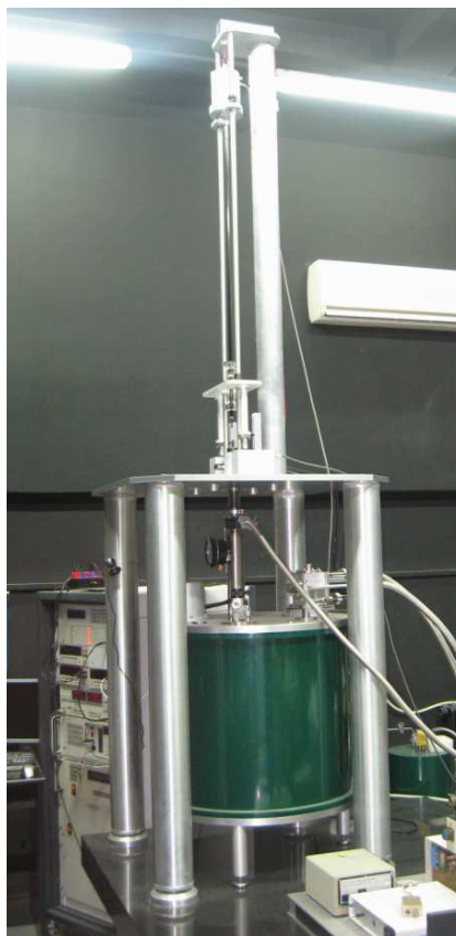
Slika 4.4: Magnetometar VSM 2000 u Centru za fiziku čvrstog stanja i nove materijale Instituta za fiziku u Beogradu.
