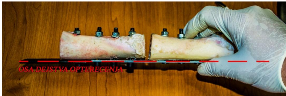
Slika 6.11 Primena dodatnog pločastog elementa u cilju pozicioniranja sklopa, kao i prenosa opterećenja u ravni
