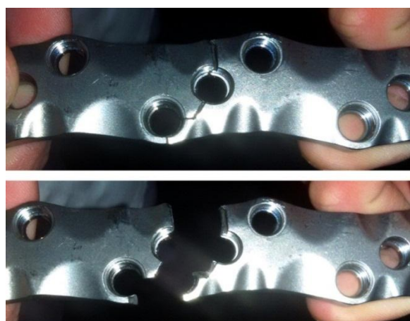
Slika 2.28. Lom ortopedskog implanta
