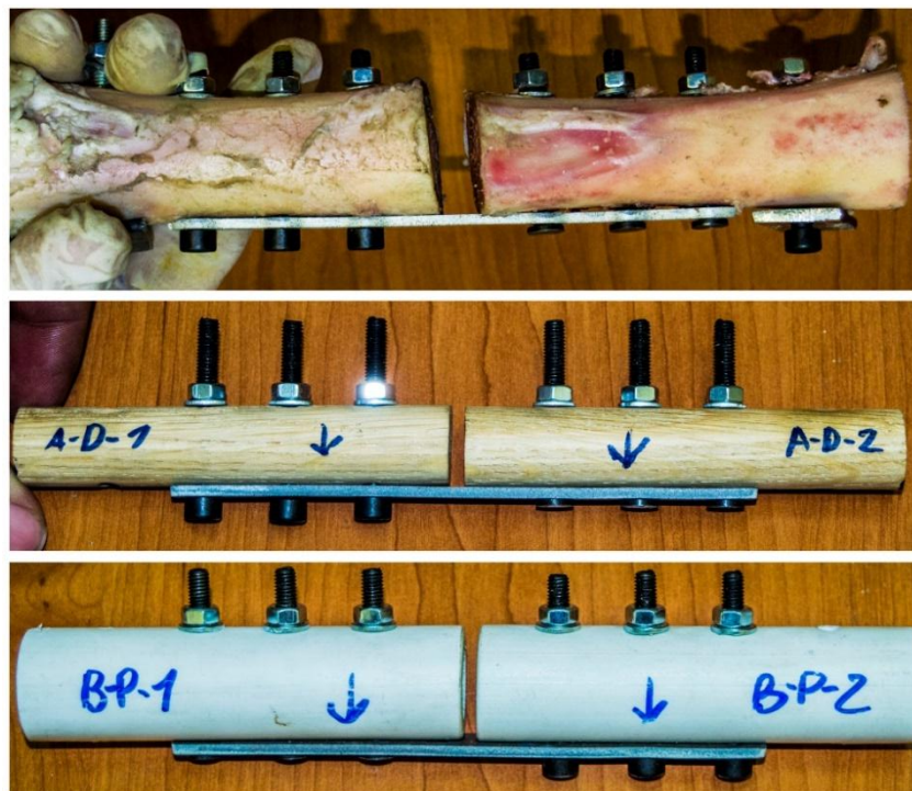
Slika 6.10 Eksperimentalna postavka veze između simuliranih prelomljenih kostiju i pločice
