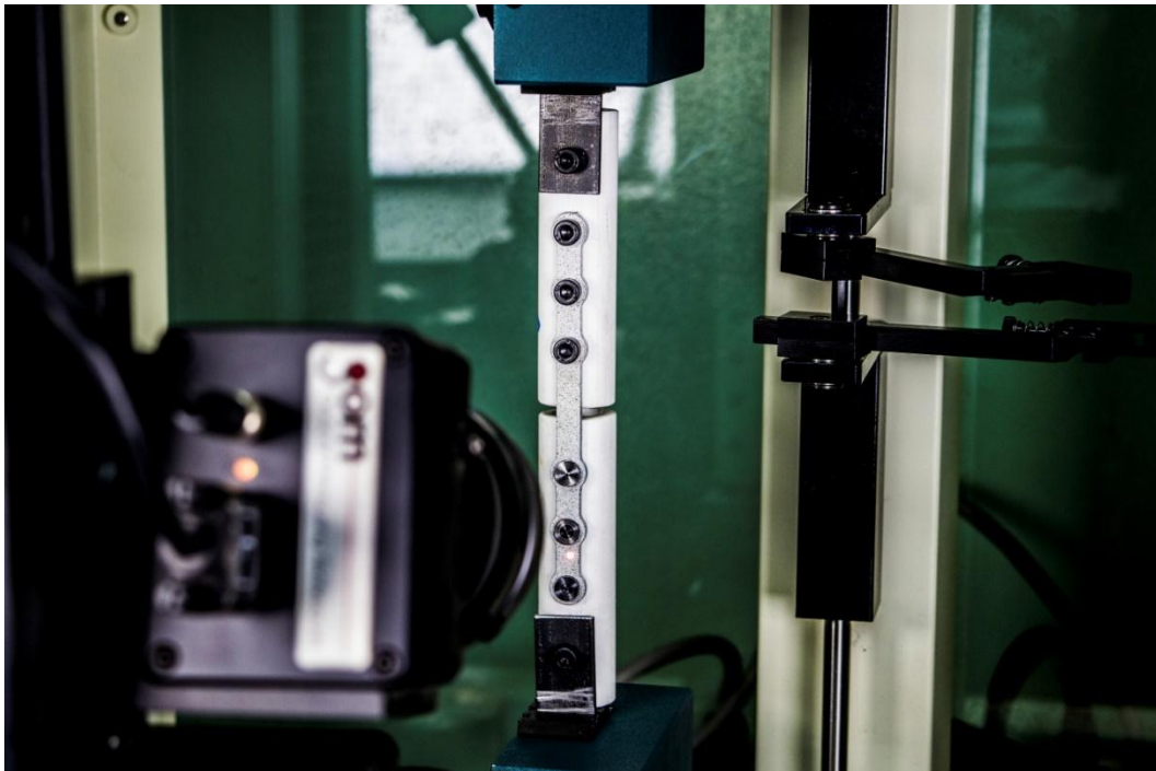
Slika 6.8 Eksperimentalna postavka uzorka simulirane prelomljene kosti sa otvorima za kontakt sa pločicom i kidalicom
