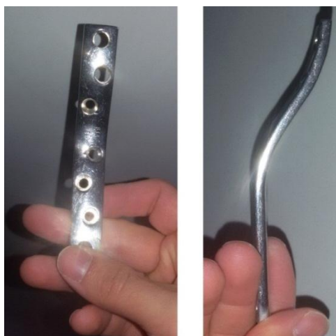
Slika 2.27. Deformacija ortopedskog implanta za vreme eksploatacije
