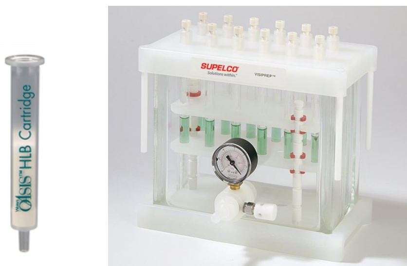
Slika 10. Prikaz kertridža i aparature za izvođenje metode ekstrakcije na čvrstoj fazi
